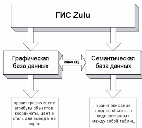
Рисунок 4.1. Структурная схема представления информации в системе Zulu
